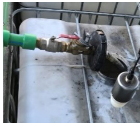
Transmetteur de niveau OPTIWAVE 1400 suspendu au-dessus d'une cuve GRV
