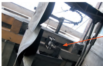
L'OPTIWAVE surveille le remplissage des wagons de train
