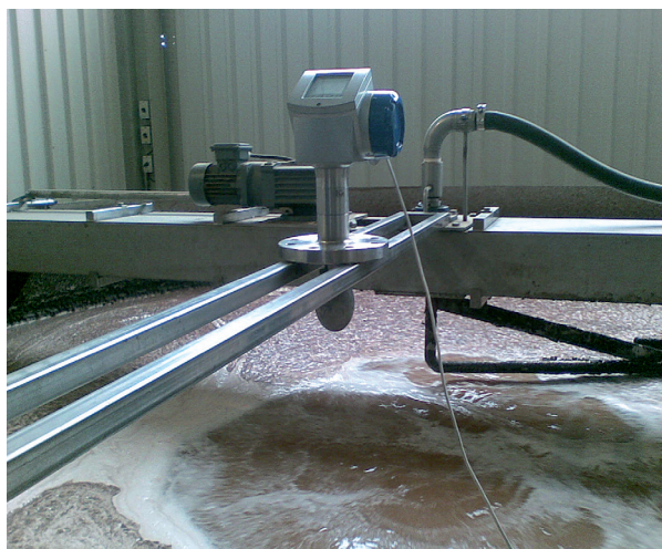
L'OPTIWAVE 7300 mesure la réflectivité à la surface du produit
