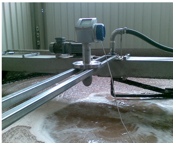
El OPTIWAVE 7300 mide la reflectividad de la superficie del producto
