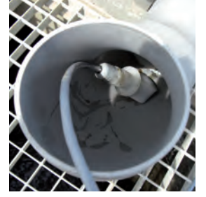
Akış ölçer çıkışında referans metre olarak iletkenlik ölçer
