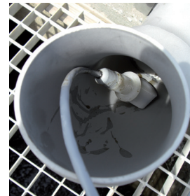
Nachgeschaltetes Leitfähigkeitsmessgerät als Referenz
