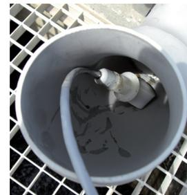
Appareil de mesure de la conductivité électrique utilisé en aval comme référence
