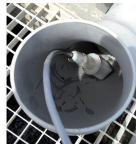
Прибор для измерения проводимости на выходе трубопровода в качестве эталонного прибора
