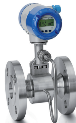
OPTISWIRL 4070 C со встроенной компенсацией по давлению и температуре (контур давления расположен с обратной стороны блока)
