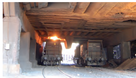
Befüllung eines Torpedowagens
