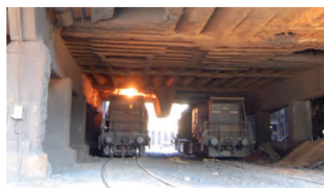
Chargement d'un wagon Torpedo
