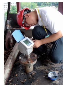
OPTIWAVE 6300 C Montage sur le toit du silo
