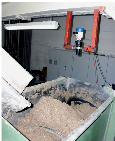
OPTISOUND 3010 über dem Mischbehälter, eine der Schnecken ist zu erkennen.
