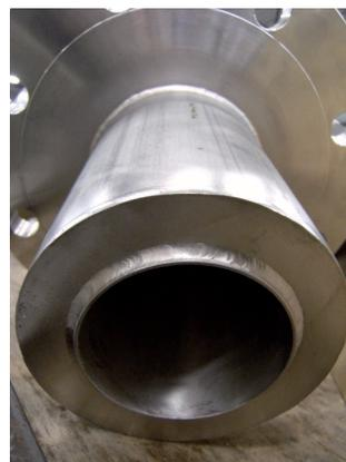
DN80 Antenne mit Heizsystem
