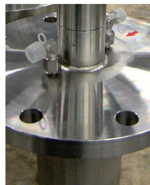
Conexiones G 3/8 para el sistema calefactor
