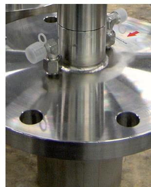
Raccordements G 3/8 pour système de réchauffage
