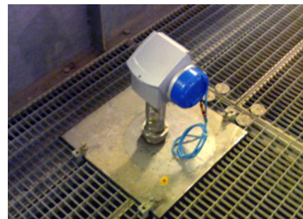
Oben am Trichter montierter OPTIWAVE 6300 C
