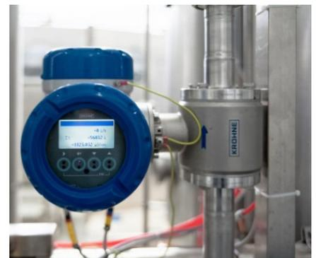
Magnetisch-induktives Durchflussmessgerät OPTIFLUX 6300
