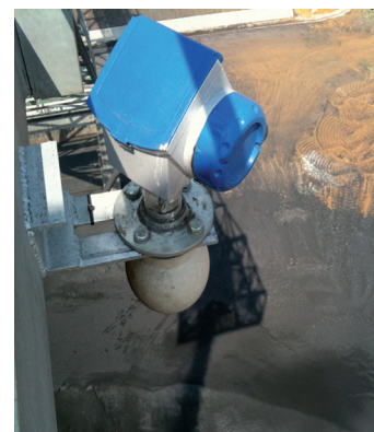
OPTIWAVE 6300 C montado en una cinta transportadora
