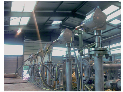
Füllstandmessung von Zementschlämme mit dem OPTIFLEX 1300 C
