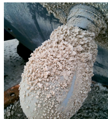
Antena elipsoidal del OPTIWAVE 6300: la medida no resulta afectada por el polvo depositado
