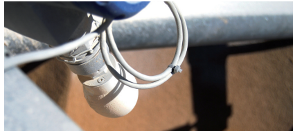
OPTIWAVE 6300 C mit DN80 PP Tropfenantenne an Abwurfförderband zur Messung des Füllstands von Halden
