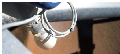
OPTIWAVE 6300 C avec antenne Drop DN 80 PP sur chariot verseur pour mesurer le niveau du tas
