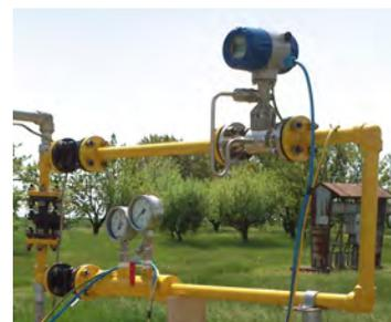
Système de mesure mobile OPTISWIRL 4070 C monté par bride
