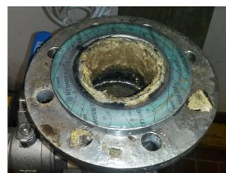
Rohrleitung aus der Co-Vergärung mit starken Fettablagerungen
