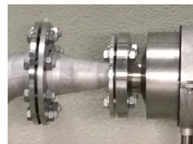
Einbau in verjüngte Rohrleitung
