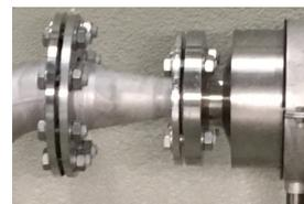
Installation sur un tuyau avec réductions coniques
