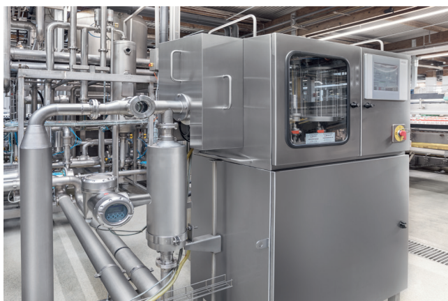
Mesure du débit volumique de boissons avec l'OPTIMASS 1400 C
