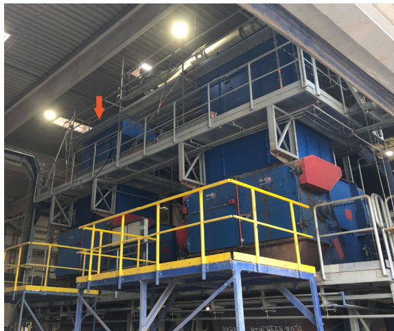
Kontejner s plasty s měřicím místem pro OPTIWAVE 6500 (červená šipka)
