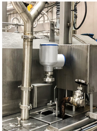
Füllstandmessung von heißem Speiseöl
