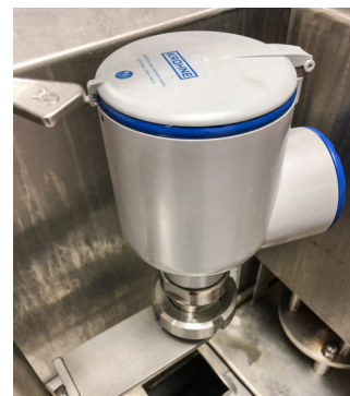
Frontbündig montiertes FMCW-Radar
