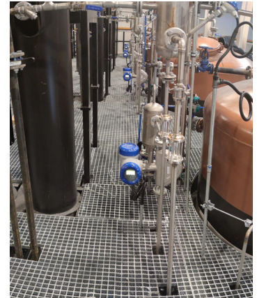
Messung von Durchfluss- und Alkoholkonzentration in der Raki-Herstellung
