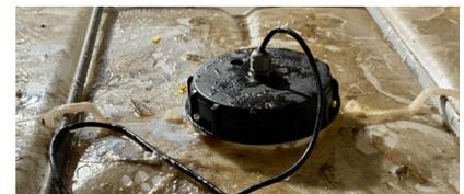
Zuvor installierter Drucksensor zur Füllstandmessung in den IBC-Tanks
