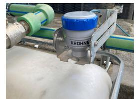
Füllstandmessung durch das Kunststoffdach eines IBC-Tanks
