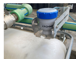
Mesure de niveau à travers des réservoirs en plastique type IBC (GRV)
