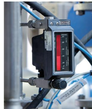
Измерение расхода азота с помощью DK 37
