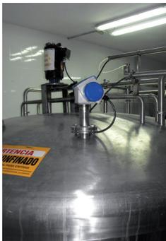
Das im Tank enthaltene Volumen wird von dem OPTIWAVE 7300 C kontinuierlich (in Echtzeit) gemessen und angezeigt. Das Radar-Füllstandmessgerät OPTIWAVE 7300 C wurde speziell für flüssige Produkte entwickelt und arbeitet nach dem FMCW-Prinzip (Frequency Modulated Continuous Wave) berührungslos.
