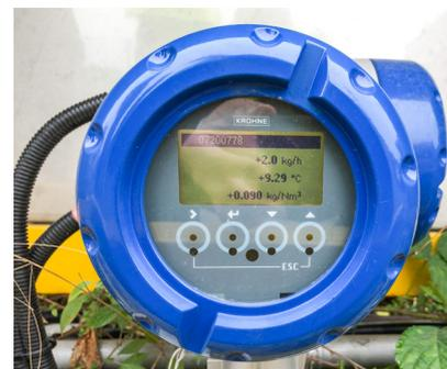
Измерение суммарного потребления водорода с помощью кориолисового массового расходомера OPTIMASS 6400 (DN15)
