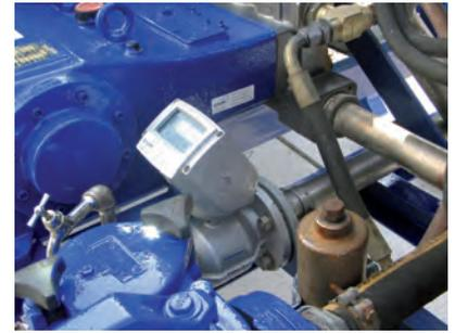
Plataforma de mantenimiento con el WATERFLUX 3070 para el mantenimiento de pozos
