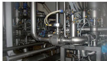
OPTIFLUX 6000 F в цикле промывки пресной водой
