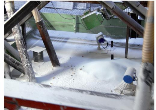
Füllstandmessung des Glasgranulats mit dem OPTIFLEX 1300
