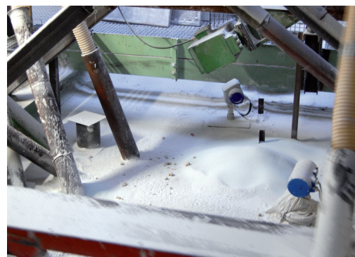
Измерение уровня стеклянного гранулята с использованием OPTIFLEX 1300
