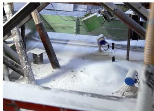
Mesure du niveau de granules de verre avec l'OPTIFLEX 1300
