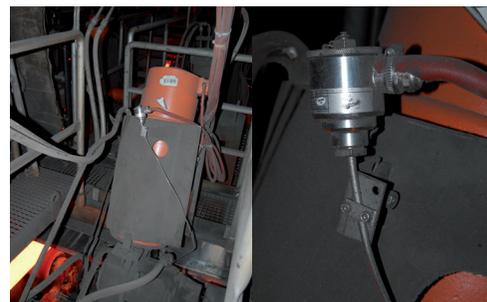
Tête de raccordement d'OPTITEMP TRA-P14 montée sur une chemise de moteur refroidie par eau
