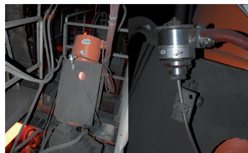
Соединительная головка OPTITEMP TRA-P14 на водоохлаждаемой рубашке двигателя
