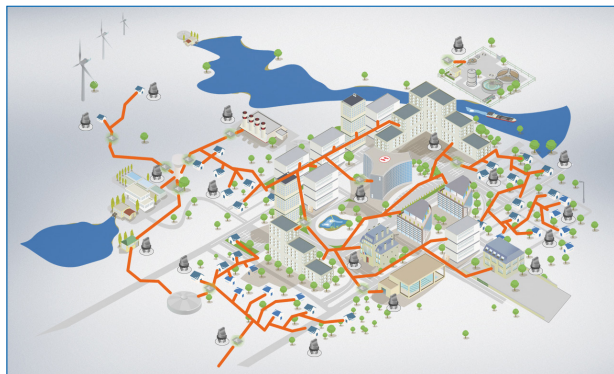
使用 GPRS 模块的测点布局示意图
