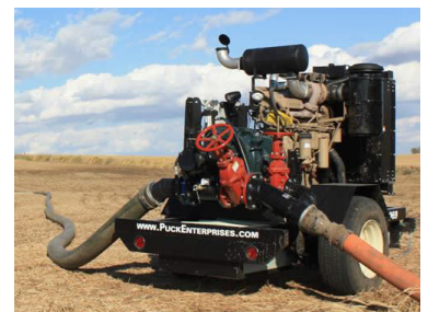
Pumpenwagen von PCE
