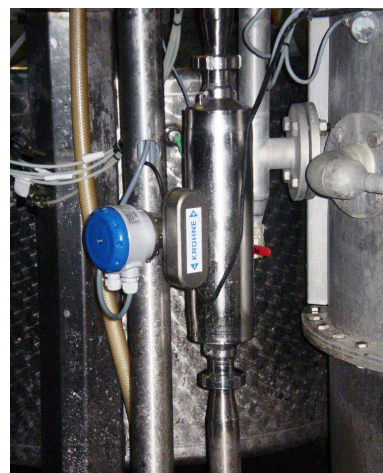
Messung von vergorener Kartoffelmaische mit dem OPTIMASS 1300
