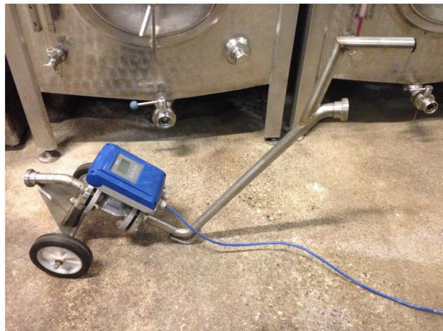
Appareil de mesure portable intégrant l'OPTIFLUX 2100
