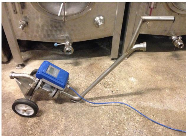
Переносной измерительный прибор с установленным OPTIFLUX 2100
