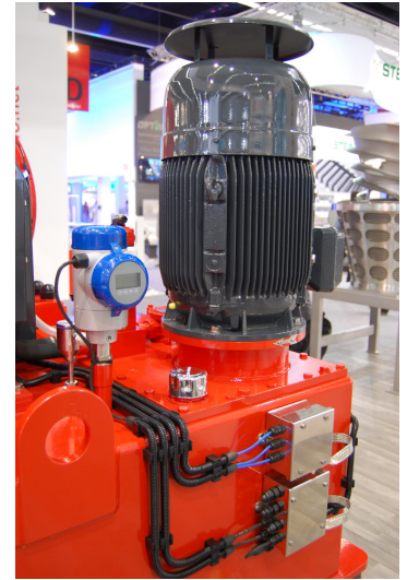
Ölstandüberwachung in einer Schubzentrifuge mit dem OPTIFLEX 2200 C
