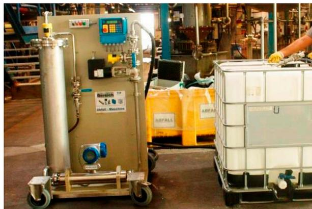
Mobile Messanlage mit dem OPTIMASS 7300 C
